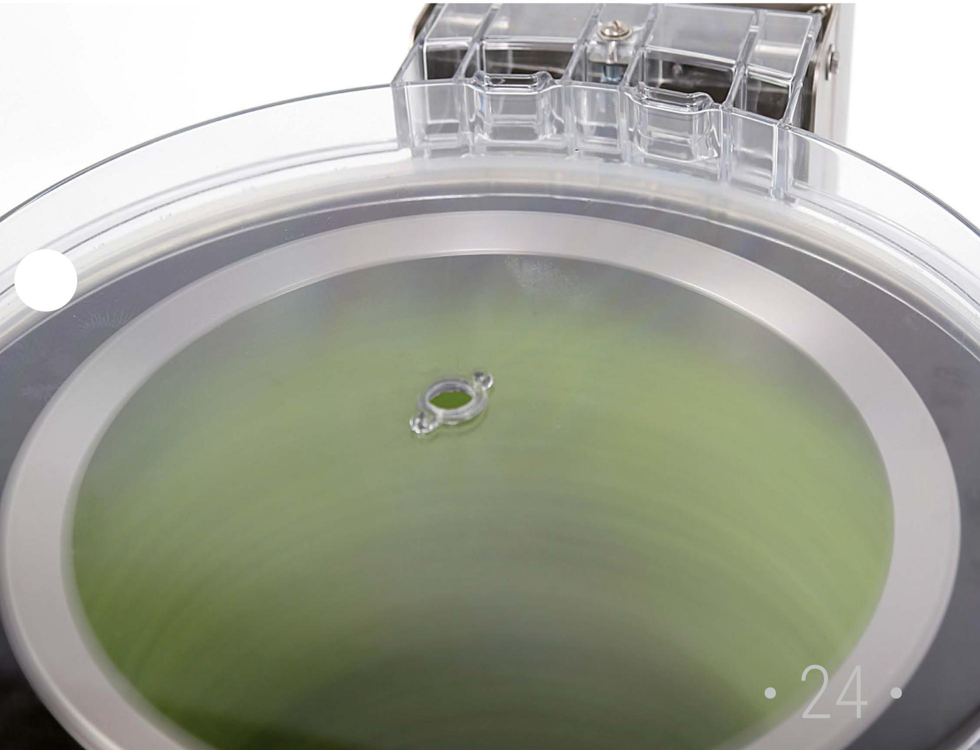
Im Deckel ist eine Sicherheitsvorrichtung eingebaut, die das Gerät unverzüglich anhält, wenn der Deckel geöffnet wird und die Inbetriebnahme bei offenem Deckel verhindert.
